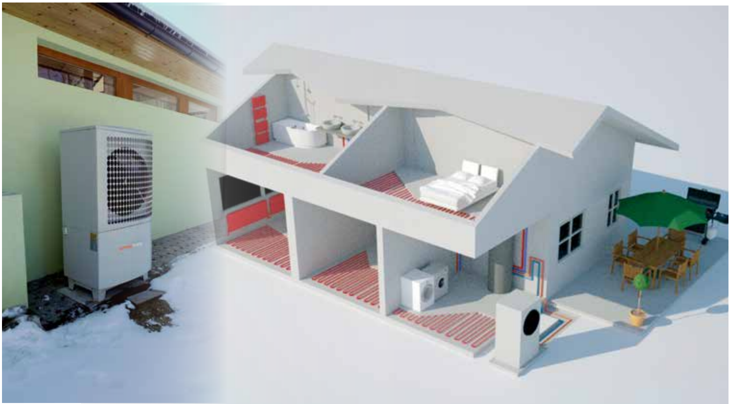
>> Toplotna črpalka samostojno ogreva hišo s talnim ogrevanjem in sanitarno vodo
